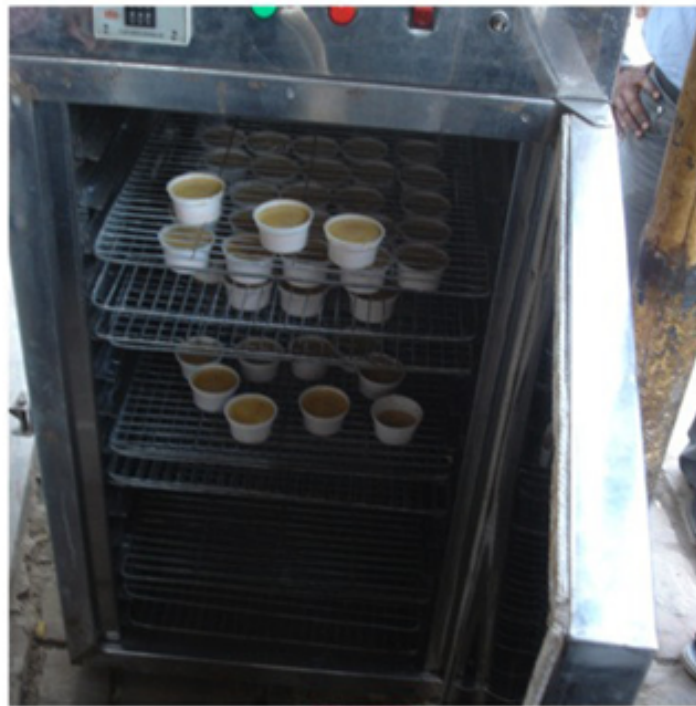
Mesin dadih digunakan untuk membuat yoghurt di Bangladesh
